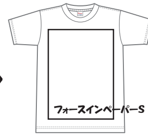
③ 転写紙の台紙を剥がしたら、フォースインペーパー-Sで再プレス。
